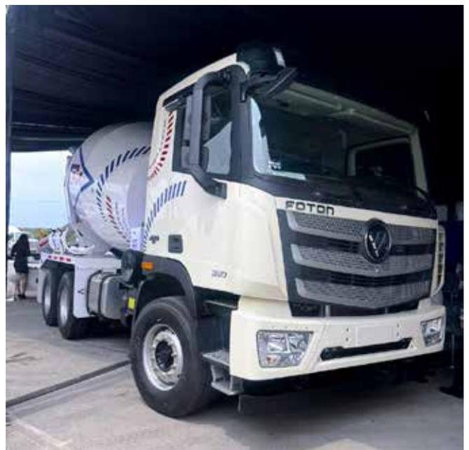
**F**ruto de esta colaboración, ambas marcas presentan al mercado nacional una solución robusta, eficiente y altamente competitiva: el nuevo Mixer S38, que integra la potencia del chasis Foton S38, equipado con motor Cummins y transmisión ZF, con la reconocida olla revolvedora UMixer MTM de 8m<sup>3</sup>.
